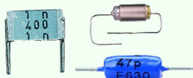
Abbildung 5-8: MKT- (links), Styroflex- (oben) und Polypropylen-Kondensator (rechts)
