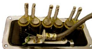
Bild 1-25: Höhenverstellbare Magnete beim Rowe DeArmond (Sicht von unten)
