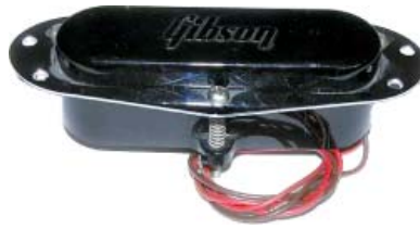
Bild 3-4: Niederohmiger koaxialer Humbucker von Gibson
