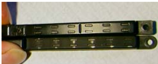
Bild 7-3: Hex-Pickups für das VG-8-System
