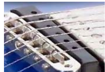
Bild 7-2: Hex-Pickup der „Gibson Digital“
