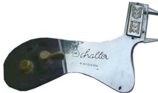
Bild 1-29: „Schwebender“ Tonabnehmer für eine Jazzgitarre von Schaller
